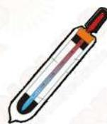
**Tecnología HeatPipe:** Tecnología anticongelante, de una muy baja pérdida de calor, no lleva retenes ni agua en tubos y su grueso tanque interno permite presiones de hasta 2kg/cm<sup>2</sup> de forma directa.
